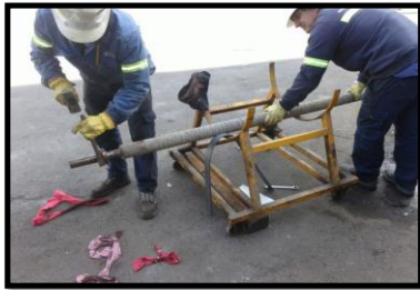
CAMBIO DE RODAMIENTOS RODILLO SALIDA PLOMO
